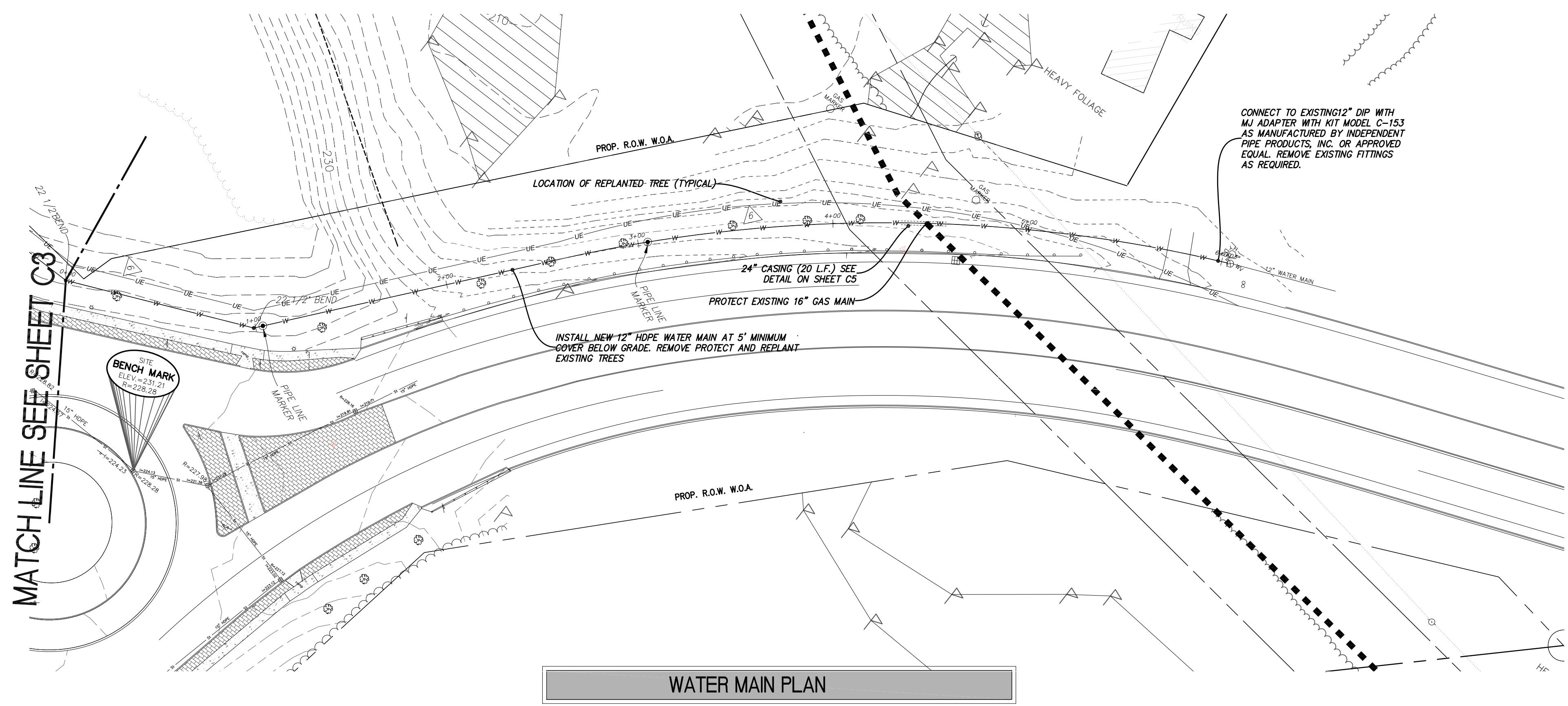
NOTE: INSTALL PIPE LINE MARKERS IN ACCORDANCE WITH TOWN'S STANDARD SPECIFICATION FOR THE WATER MAIN SHOWN HEREON.
