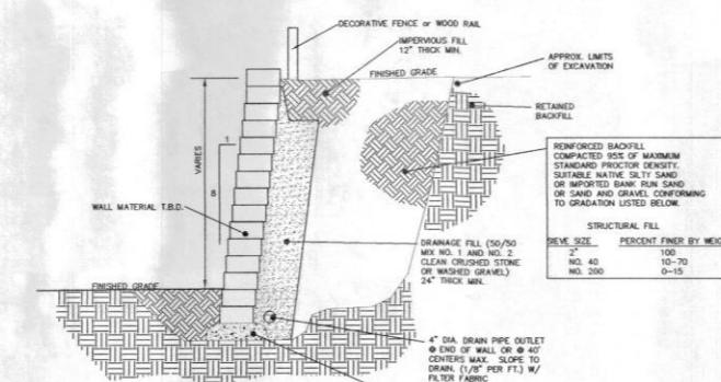
6 8 TYPICAL RETAINING WALL DETAIL
